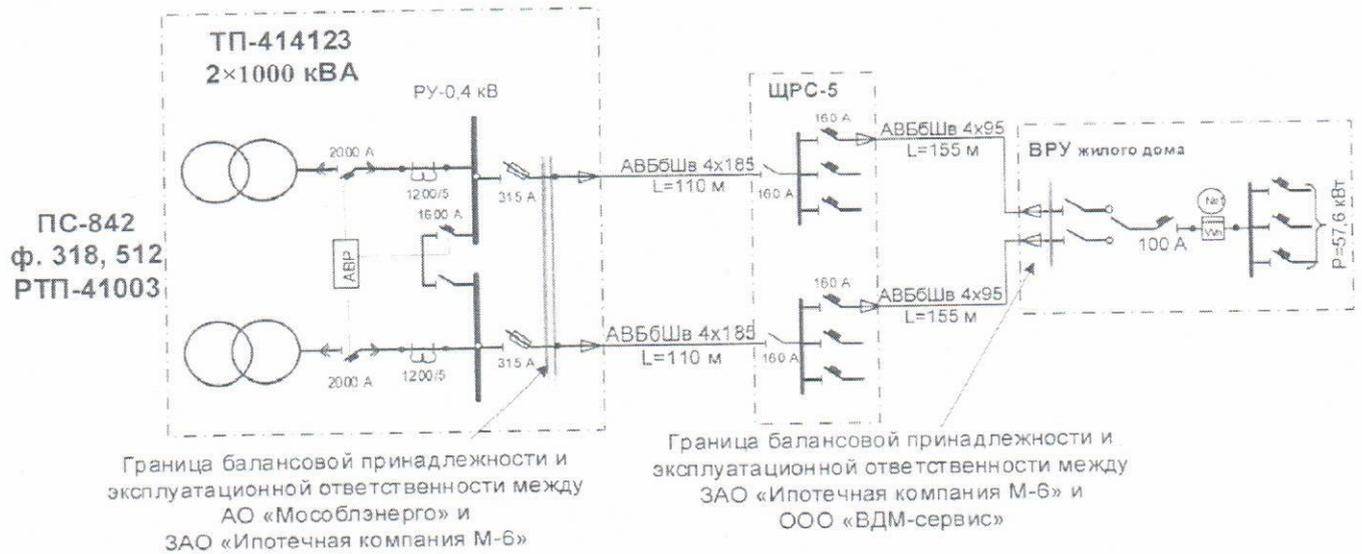
**Примечание:** в схеме указываются места установки и номера приборов учета, параметры измерительных трансформаторов тока и напряжения, границы балансовой принадлежности (красный цвет) и эксплуатационной ответственности (синий цвет), границы с субабонентами (зеленый цвет), длина и марка питающих кабелей (проводов).
